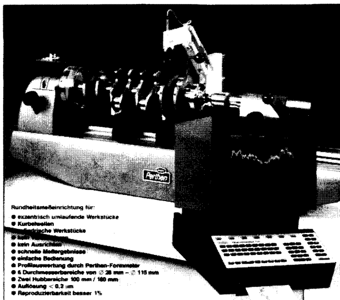
101. ábra. A körkörösségmérő fejek párhuzamvezető paralelogrammakar viszi mérési helyzetbe. A mérőfej induktív mérőrendszerének felbontása 0,2 µm. 28 ... 115 mm-es átmérők ellenőrzésére alkalmas, 6 átmérőtartományban (Perthen). A Formmeter F2P típusú mikroprocesszoros egység diagramokat, adatokat szolgáltat
